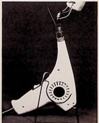
Die Austrittstemperatur liegt zwischen 400 und 430 °C. Mit dem Adapter 6958 wird der Wärmestrahle auf einen Durchmesser von 5 mm reduziert. Nähere Information durch NUCLETRON Vertriebs GmbH, Gärtnerstr. 60, 8000 München 50
