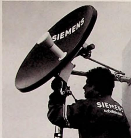
**Bild 7:** Prototyp einer Heimempfangsanlage für das 12-GHz-Satelliten-Fernsehen
