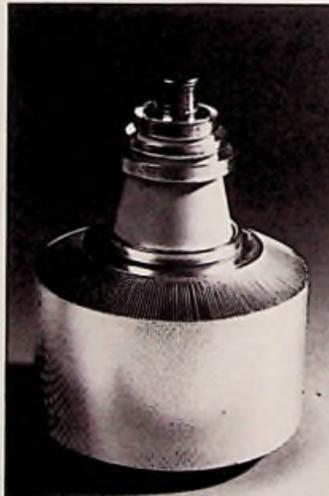
Die YL 1690 gehört zu der neuen YL 1600er Serie, die durch hohe Zuverlässigkeit gekennzeichnet ist. Wie bei allen Röhren dieser Reihe (YL 1610/1630 für VHF und YL 1640/1660 für AM) ist die Metall-Keramik-Konstruktion (Bild 1) mit Computerhilfe entworfen. Die Röhre ist luftgekühlt und mit einer Wolfram-Thorium-Maschenkatode ausgerüstet, die vollen Betrieb bereits eine Sekunde nach dem Einschalten gewährleistet. Für vergleichbare andere Röhren werden ca. 3 min Anheizzeit benötigt.
